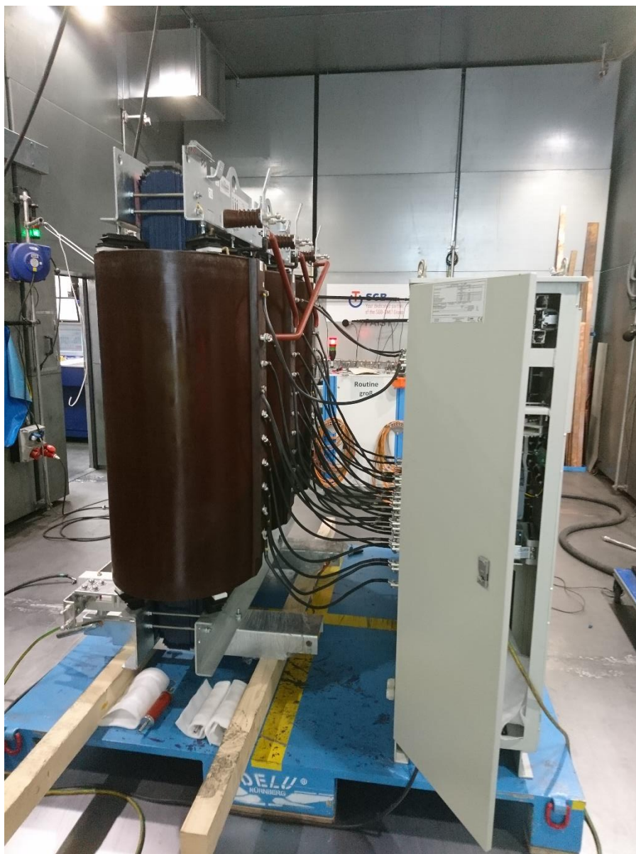
Obrázek č 2: Suchý distribuční transformátor s OLTC
