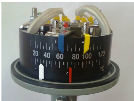
obr. 2: teploměr, čelní pohled po demontáži víka
