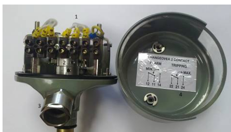
obr. 3: teploměr, zadní pohled po demontáži víka
