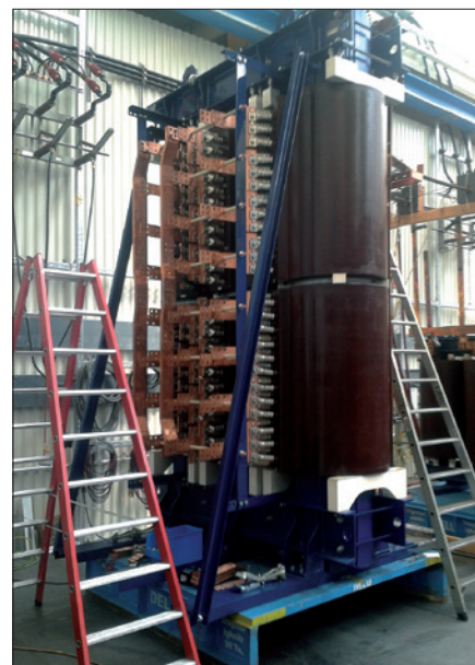
Obr. 3. Zkratový transformátor pro zkušebnu VUT Brno jmenovitý výkon 16 MV·A, napětí 6 \text{ kV} \pm 2 \times 10 \% / 1-0,75-0,5-0,25 \text{ kV} , skupina zapojení Dyn1, ztráty naprázdno P_0 = 18,4 \text{ kW} , ztráty nakrátko P_k = 64 \text{ kW} , napětí nakrátko u_k = 2,28 \% , hmotnost 25,6 t, výška 3,8 m
