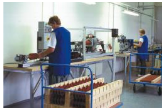
Semi-automatic special machineries for assembly of polymer arresters of modular construction / poloautomatické speciální stroje pro montáž omezovačů s vnější izolací z polymerů modulární konstrukce
