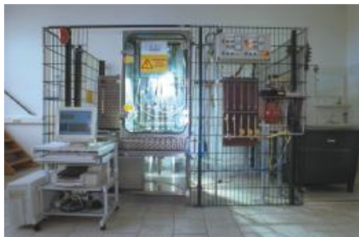
Cabine for 5000h accelerated weather ageing test / komora pro 5000 hodinovou urychlenou zkoušku stárnutí
