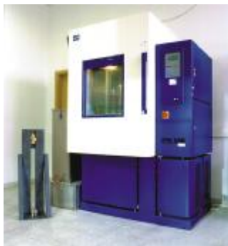
Climate Test Cell / klimatická komora
